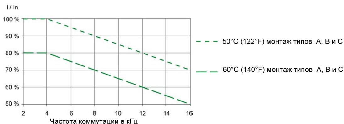
Для промежуточных температур, например, 55°C, интерполируйте между двумя кривыми.
