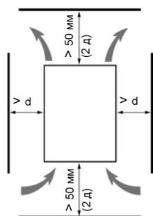
Установите устройство вертикально, с отклонением не более  $\pm 10^\circ$ .
