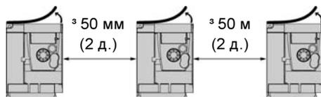
Свободное пространство  $\geq 50$  мм с каждой стороны. При температуре окружающего воздуха выше  $50^\circ\text{C}$  защитные пленки с вентиляционных отверстий должны быть сняты.
