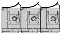
Приводы монтируются в ряд, защитные пленки с вентиляционных отверстий сняты.
