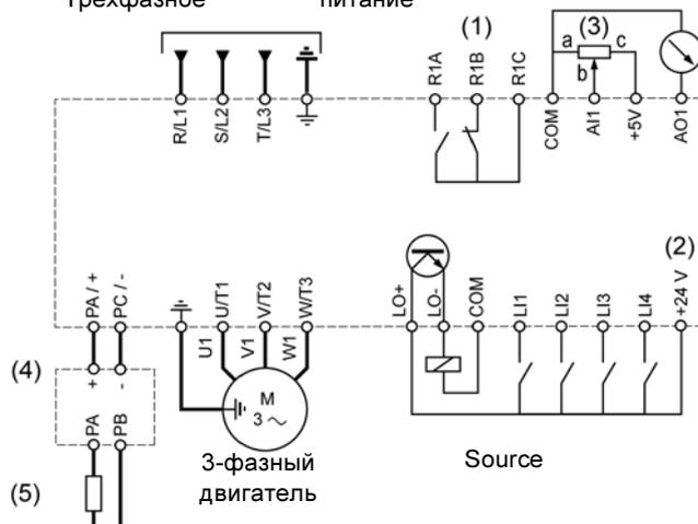
(1) Контакты реле R1 для дистанционной индикации состояния ПЧ.
