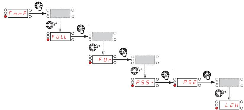
Установите параметр **Предустановленная скорость 2 S P 2** стр. 70 в 20 Гц.
