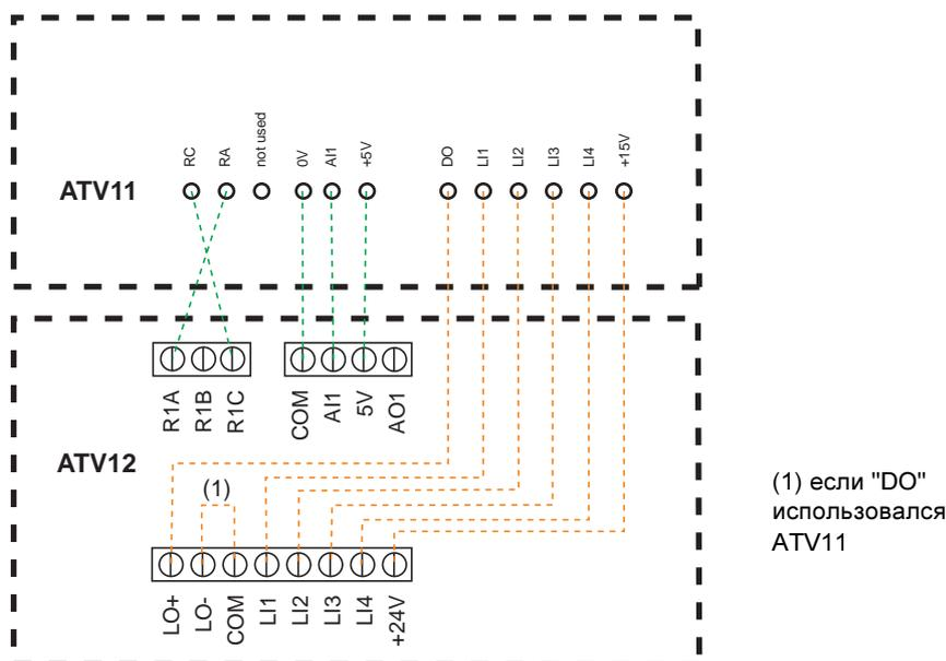
(1) На ATV11 выход DO – это аналоговый выход, который может быть сконфигурирован, как логический выход. На ATV12, в зависимости от конфигурации, DO может быть привязан к LO1 или AO1.
