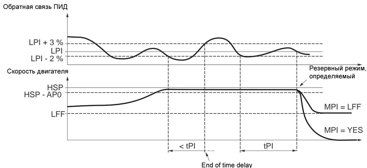
Когда насос переменной производительности работает на максимальной скорости (выше, чем HSP - AP0) и в то же время уровень обратной связи ПИД снижается ниже контролируемого порога LPI - 2%, запускается отсчет временной задержки tPI. Если по окончании отсчета значение обратной связи ПИД все еще останется ниже контролируемого порога LPI + 3%, привод переключится в резервный режим, как определено параметром MPI.
