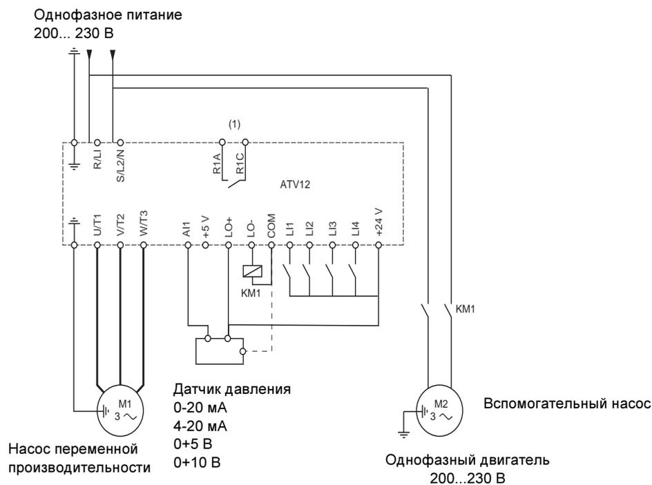
(1) Контакты реле сигнализации отказа, для дистанционной индикации состояния привода.
